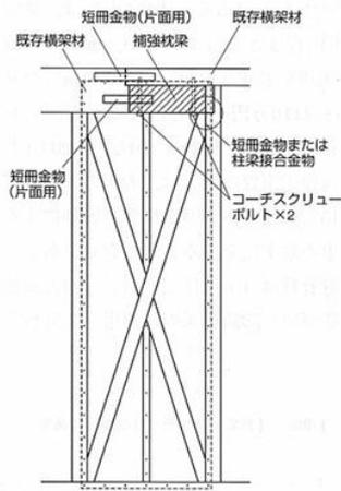
図34 耐力壁桁上部に継手がある場合
