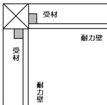
受材と柱の間に構造用合板がはさまれないようにする。
