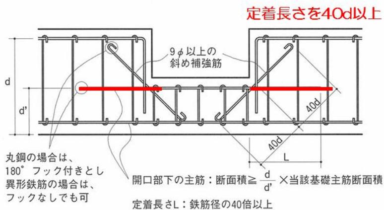
図 2.6.2.3 立上りの開口まわりの補強
